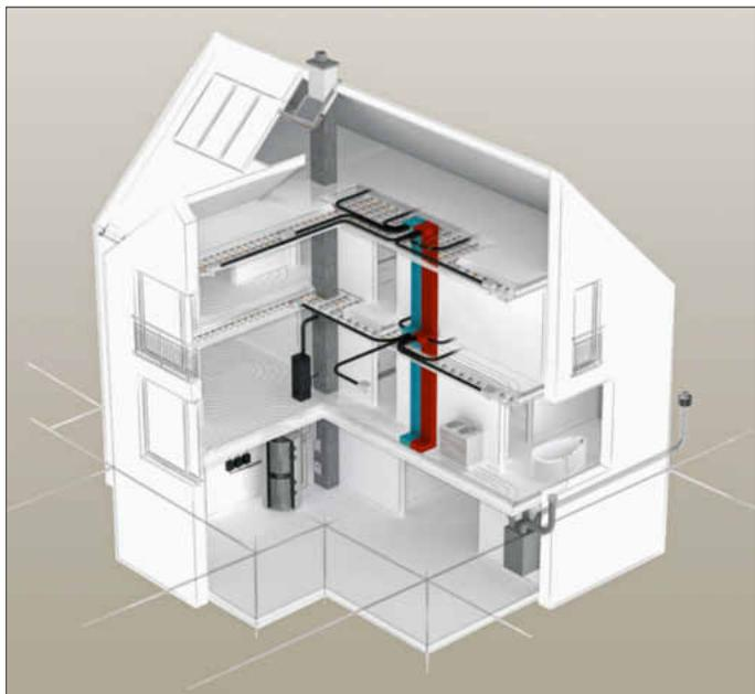
Raffinierte Konstruktion: Ein Lüftungsnetzwerk sorgt für frische Luft in den eigenen vier Wänden, ohne dass im Winter wertvolle Heizwärme verloren geht. Grafik: Erlus/interPress
